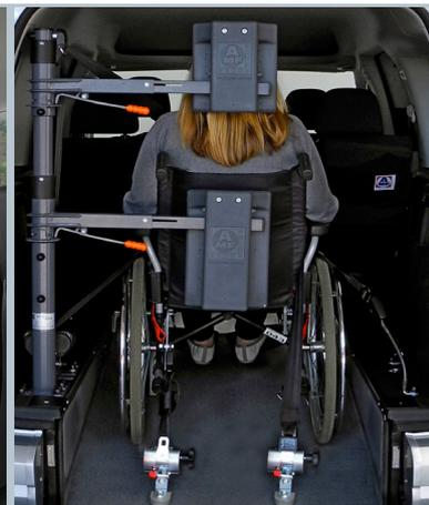
Das Fahrzeug kann mit der Kopf- und Rückenstütze FUTURESAFE ausgestattet werden.
